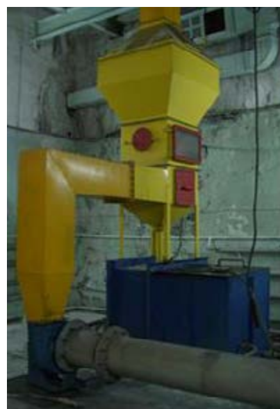
Рис. 1. Фотография промышленной установки пенной фильтрации газов
