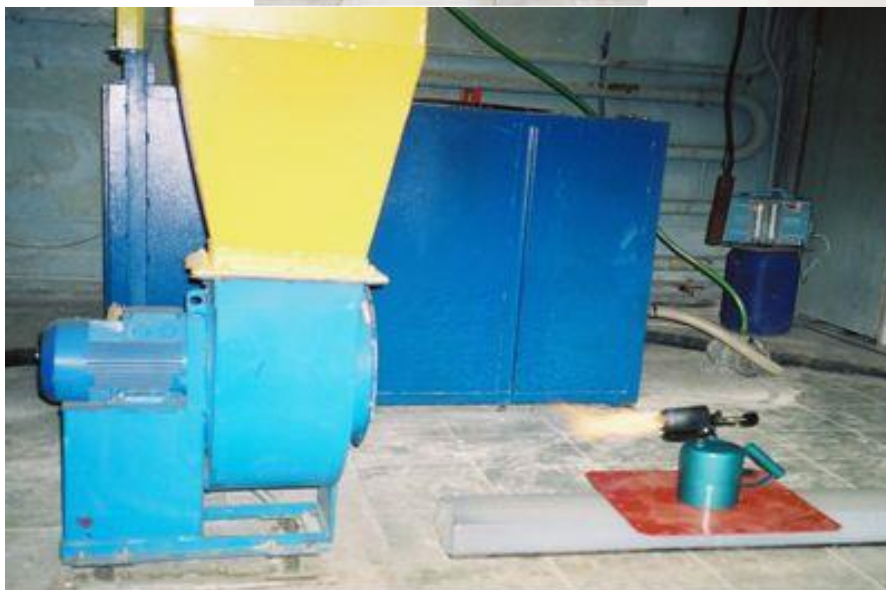
Рис. 2. Работа установки при экспериментальном определении улова оксидов азота
