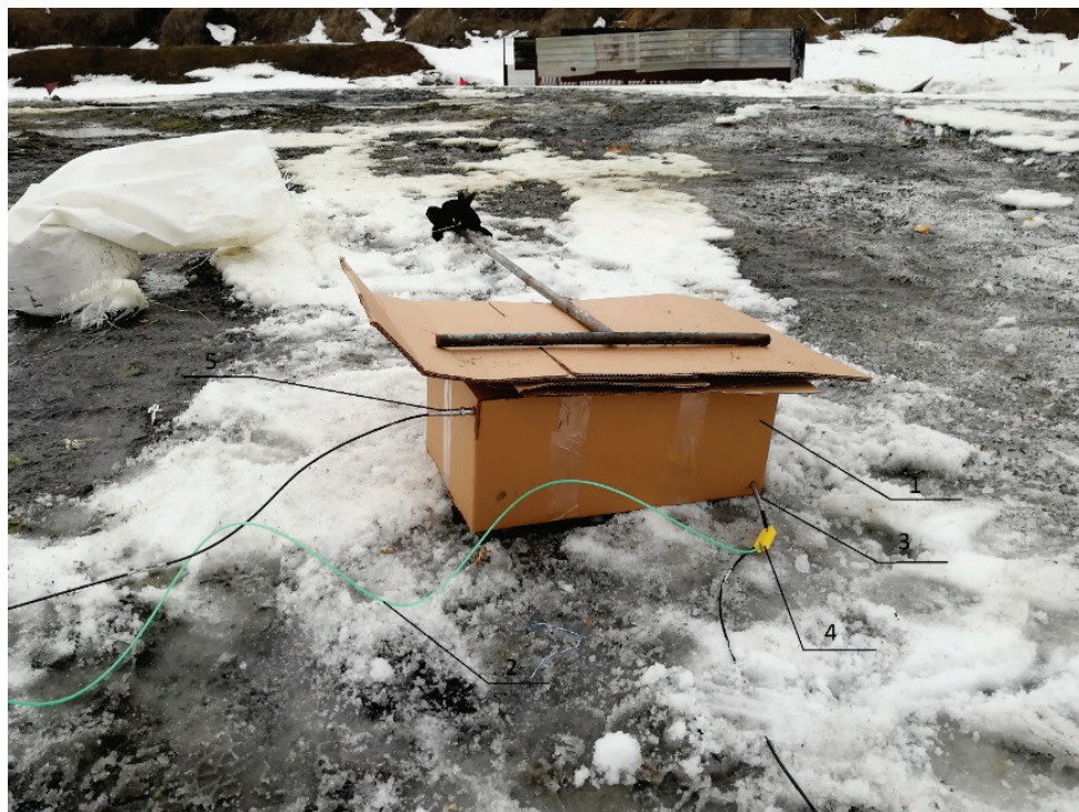
Рис. 4. Полигонная модель испытаний образцов устройств НСИ: 1 — коробка из гофрокартона для размещения в пространстве относительно друг друга датчиков и капсуль-детонатора НСИ при испытании в полигонных условиях; 2 — ударно-волновая трубка (УВТ) НСИ; 3 — капсуль-детонатор устройства НСИ; 4 — стартовый фотодиодный датчик; 5 — финишный фотодиодный датчик
