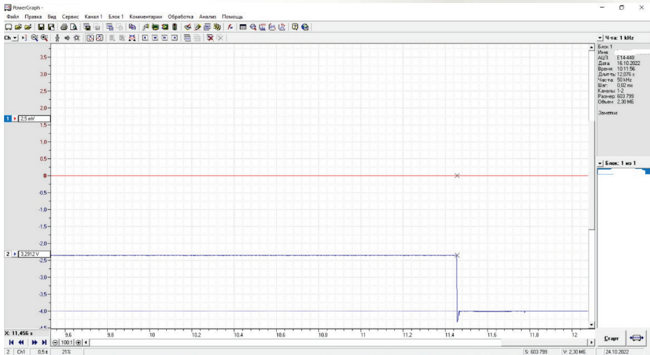
Рис. 8. Осциллограмма с указанием времени срабатывания финишного датчика (2 канал АЦП).
