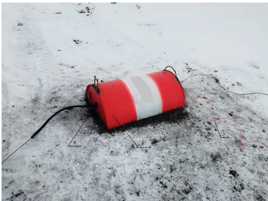
Рис. 4. Полигонная модель испытаний образцов устройств НСИ: 1 — коробка из гофрокартона для размещения в пространстве относительно друг друга датчиков и капсуль-детонатора НСИ при испытании в полигонных условиях; 2 — ударно-волновая трубка (УВТ) НСИ; 3 — капсуль-детонатор устройства НСИ; 4 — стартовый фотодиодный датчик; 5 — финишный фотодиодный датчик
