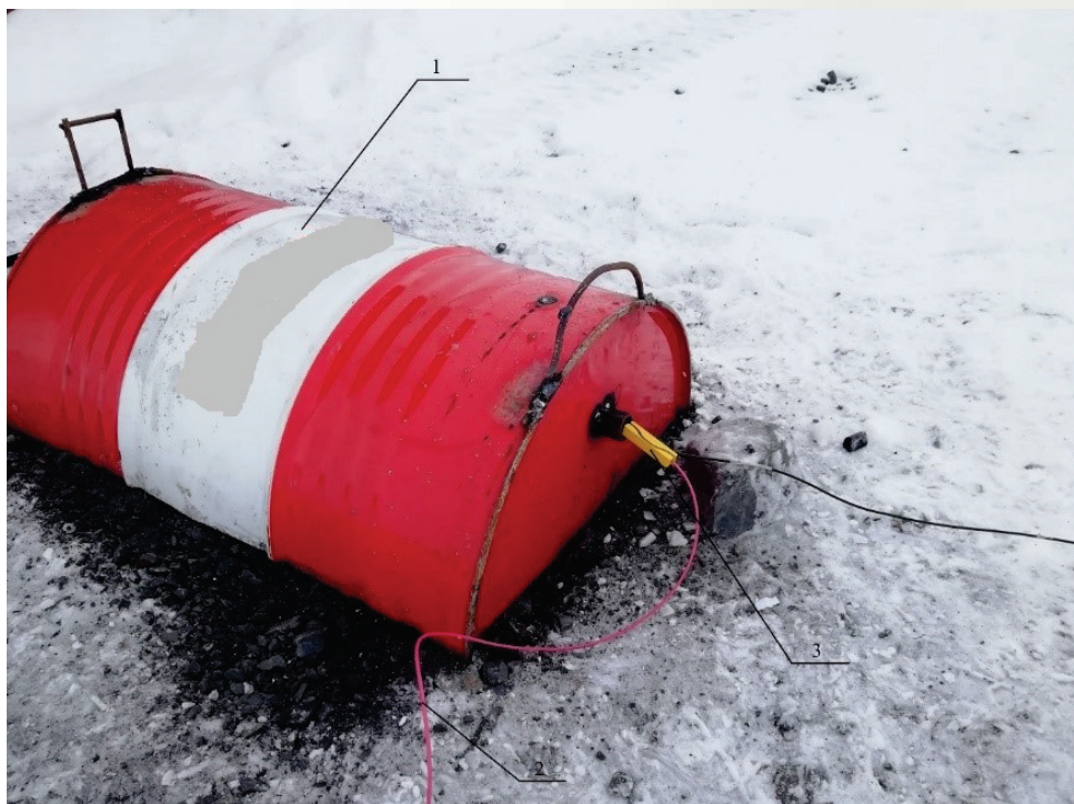
Рис. 5. Полигонная модель испытаний образцов устройств НСИ: 1 — металлическая бочка (200 л) для размещения в пространстве относительно друг друга датчиков и капсуль-детонатора НСИ при испытании в полигонных условиях; 2 — ударно-волновая трубка (УВТ) НСИ; 3 — стартовый фотодиодный датчик; 4 — финишный фотодиодный датчик
