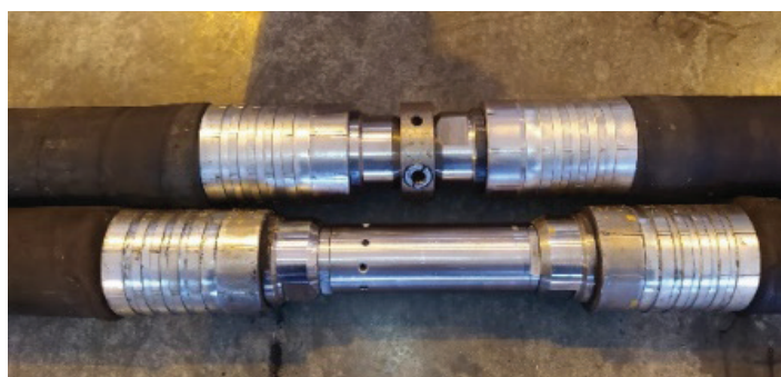
Рис. 4. Сравнительные габариты устройств гидроразрыва угольного пласта золотникового и клапанного типа.
