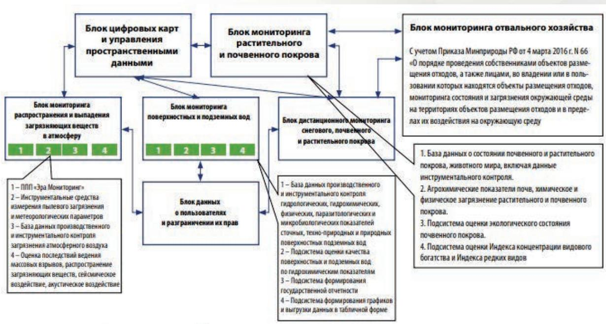
Рис. 1. Структура программно-аппаратного комплекса информационно-вычислительной системы экологической безопасности
