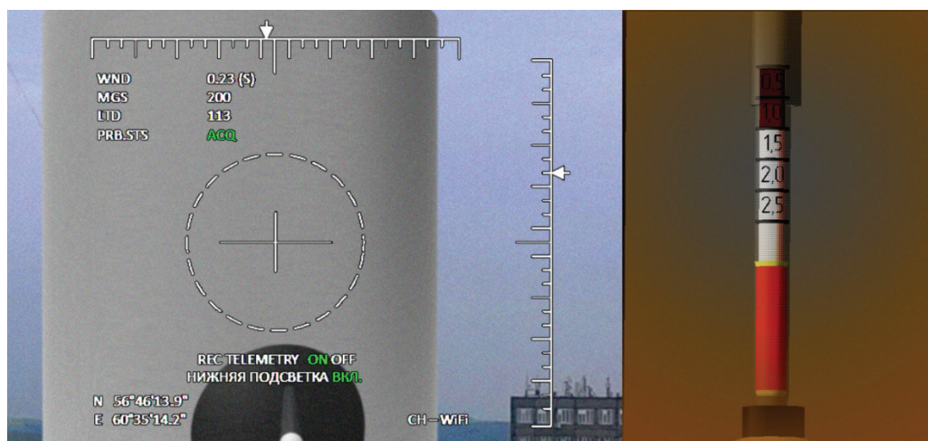
Рис. 3. Вид от камеры дрона на место пробоотбора и на индикаторную трубку в подвесе (рисунок авторов)
