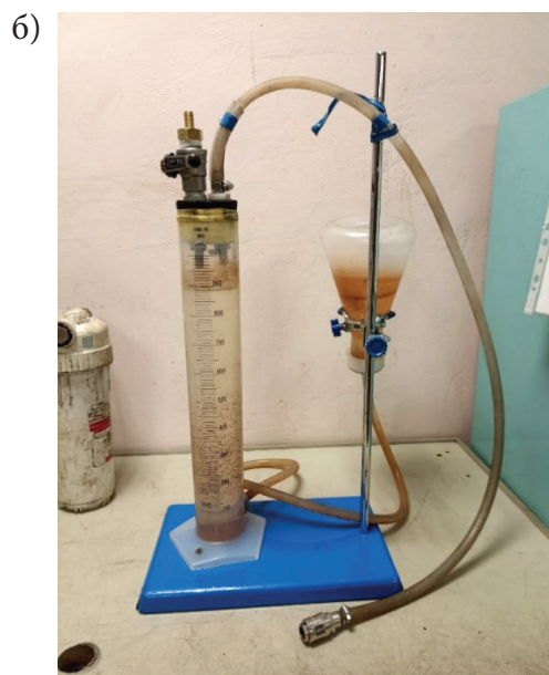
Рис. 3. Оборудование для проведения десорбционных тестов: а) Герметичный сосуд для угольных проб; б) Измерительный комплекс
