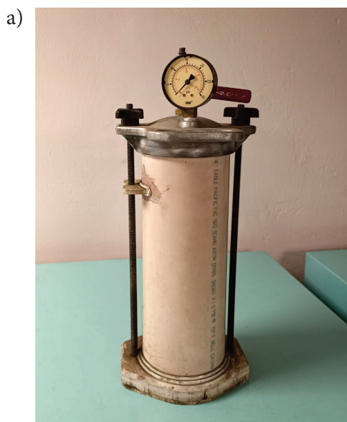
Рис. 3. Оборудование для проведения десорбционных тестов: а) Герметичный сосуд для угольных проб; б) Измерительный комплекс
