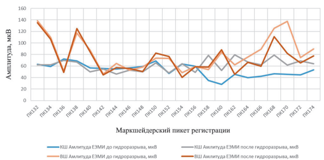
Рис. 3. График изменения амплитуды сигнала до и после гидровоздействия вдоль каждой выработки
