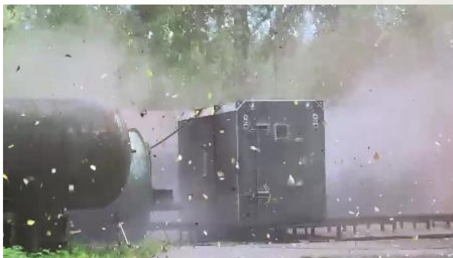
Рис. 6. Внешний вид испытательного стенда и испытываемого ППС при взрыве метановоздушной смеси
