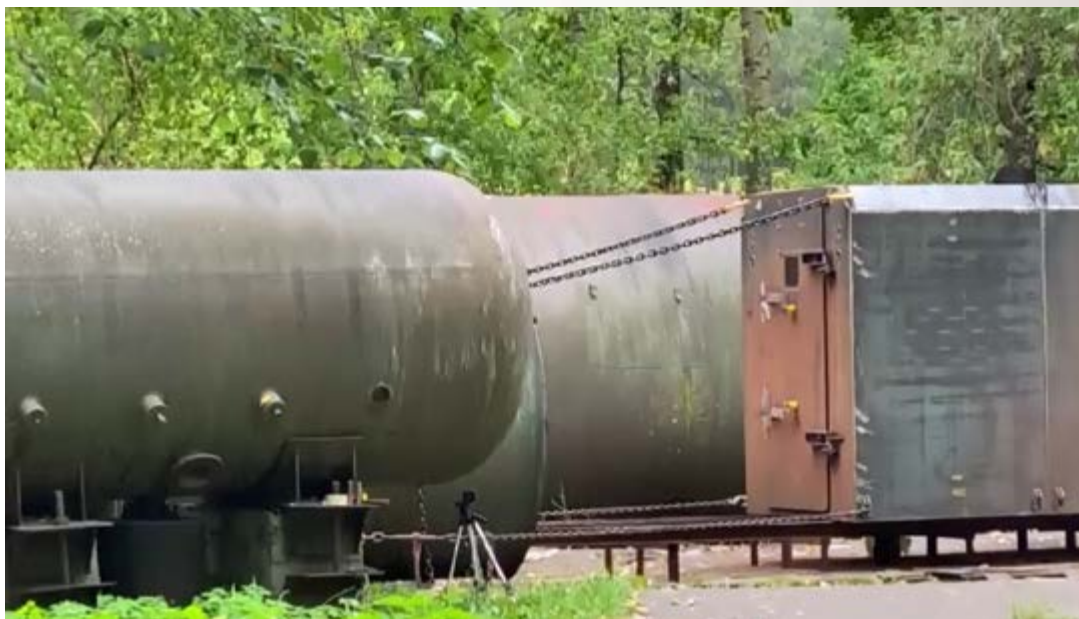
Рис. 2. Внешний вид испытательного стенда при испытании боковой сторона корпуса ППС (боковая сторона корпуса ППС с входной дверью)
