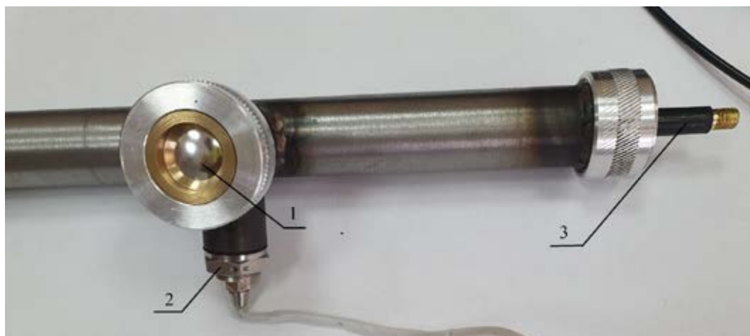
Рис. 4. Внешний вид калибровочной оснастки с установленным датчиком: 1 — мембрана, которая при нарушении целостности (прокалывании) вызывает скачок давления внутри оснастки; 2 — датчик давления ЛХ-610; 3 — ниппель для подключения компрессора (источника создания давления в оснастке) и поверенного манометра с целью фиксирования созданного давления
