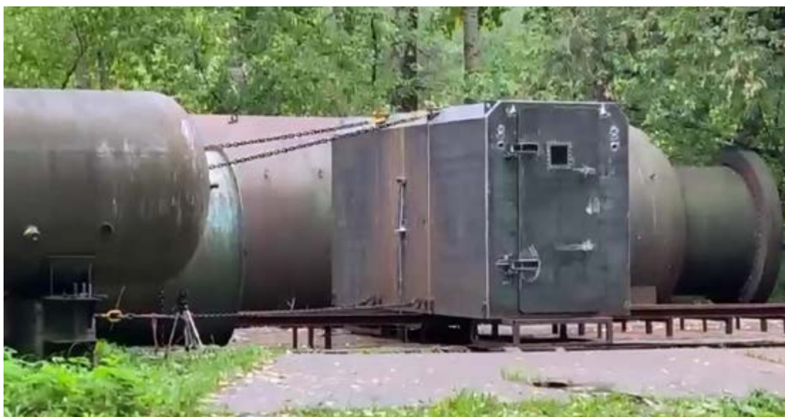
Рис. 3. Внешний вид испытательного стенда при испытании боковой стороны корпуса ППС (боковая сторона, состоящая из 3-х, соединенных болтовым соединением секций ППС)
