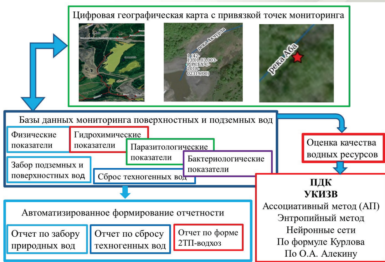
Рис. 2. Структура программно-аппаратного комплекса мониторинга техноприродных вод
