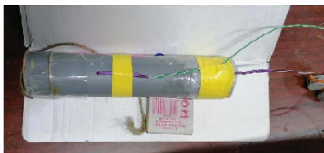
Рис. 3. Подготовленный для измерения скорости детонации заряд Ø36 мм (коробок спичек для масштаба). Детонатор вставляется в отверстие с левого торца трубки.
