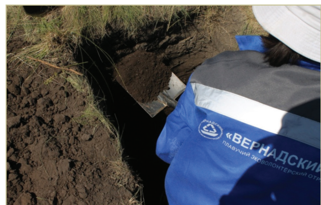
Рис. 5. Подготовка шурфа для проведения описания почвенного разреза
