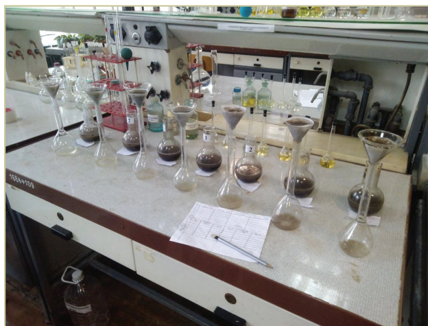
Рис. 9. Процесс фильтрования водных вытяжек отобранных проб
