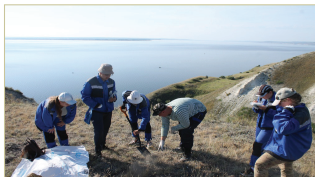
Рис. 9. Отбор проб почвы методом конверта для проведения геолого-морфологических химико-аналитических исследований почвы
