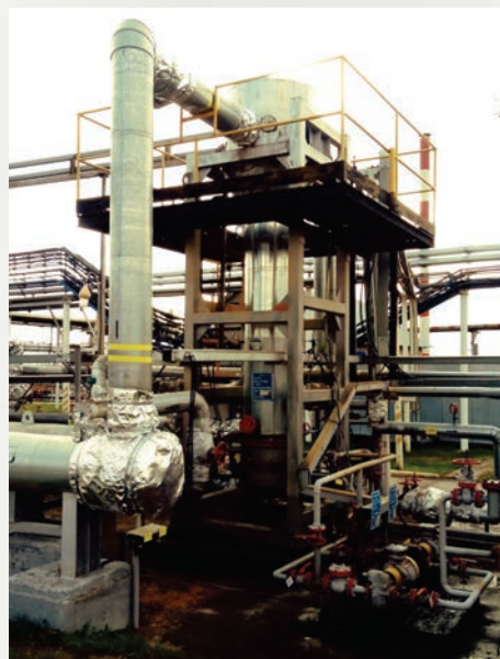
Рис. 1. Промышленная установка в Бавлинском газовом цехе. Установка очистки газов отдувки высокосернистой нефти
