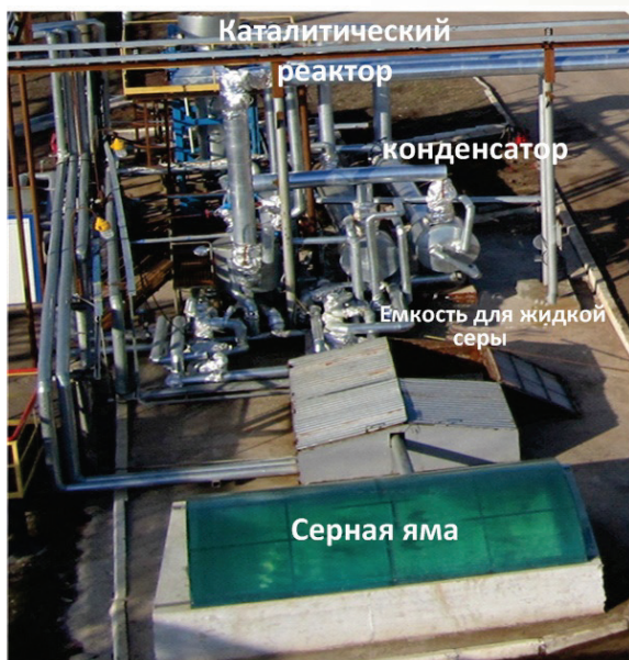
Рис. 1. Промышленная установка в Бавлинском газовом цехе. Установка очистки газов отдувки высокосернистой нефти
